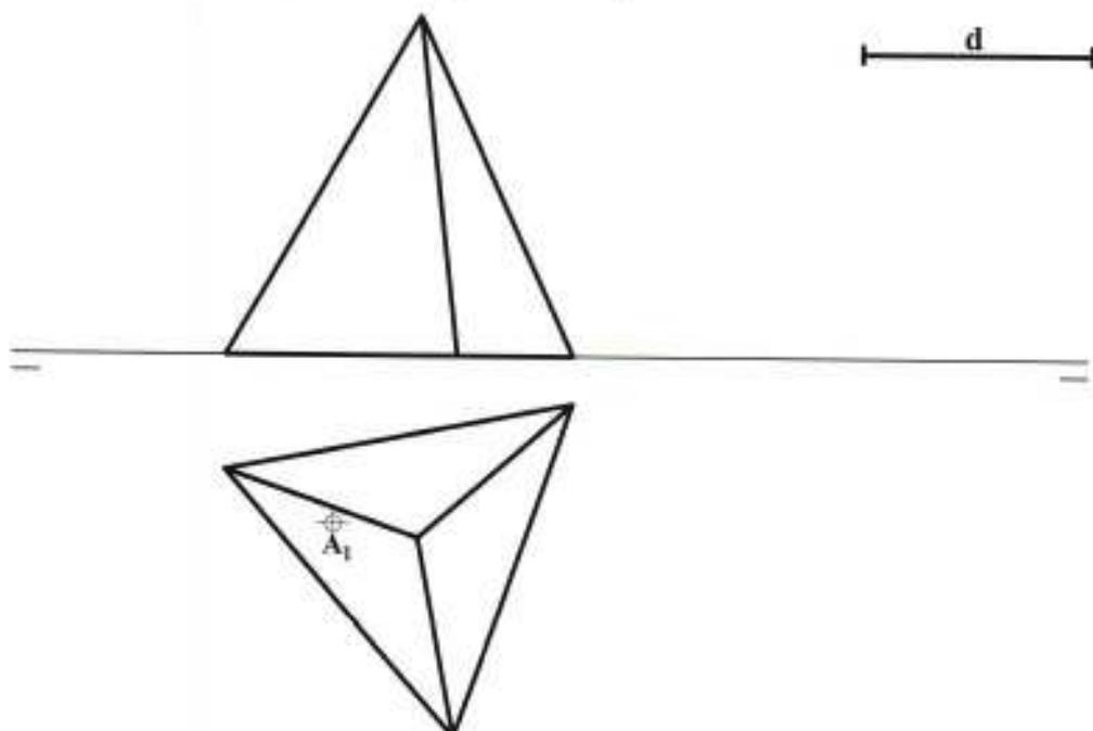
A3.- Representar en perspectiva caballera,  $C_y = 1/2$ , la pieza dada por sus vistas diédricas normalizadas. Indicar únicamente la parte visible de la pieza.
